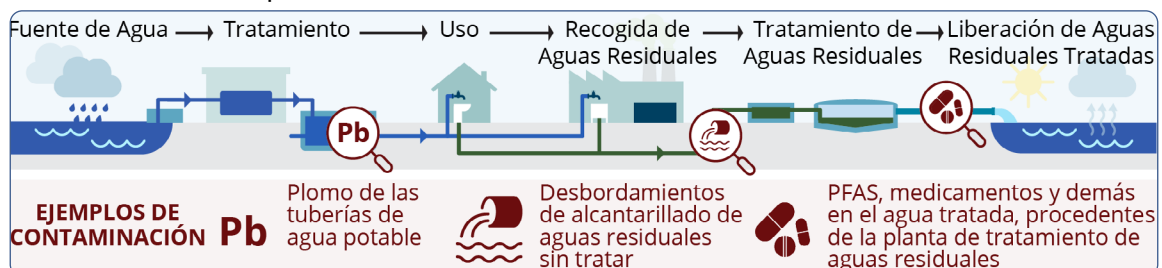
Diagrama del ciclo del tratamiento del agua y ejemplos de fuentes de contaminación.
